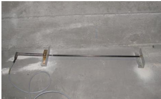
Bild 6: IWA mit 50 cm Messbasis mittels Verlängerungsstab aus Karbon Foto: Nico Steffens
