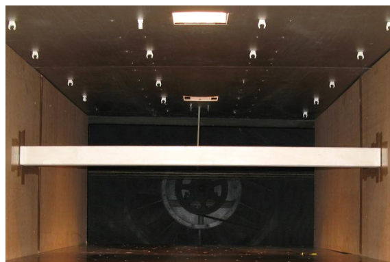
Abbildung 5: Windkanalversuch mit Abschnittsmodell eines Brückenhängers
