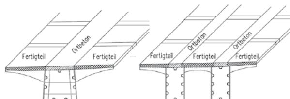
Bild 9 Möglichkeiten zur Anordnung der in Längsrichtung durchlaufenden Ortbetonstreifen und der Ortbetonquerfugen
