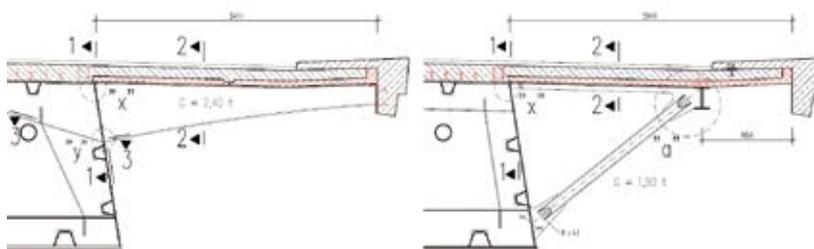
Bild 17 Querschnitte mit Konsolträgern oder mit äußeren Schrägstreben für Stahlverbund-Großbrücken mit Teilfertigteilen
