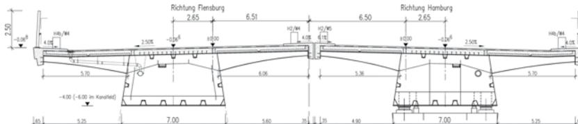
Bild 18 Rader Hochbrücke – Regelquerschnitt der abgeschlossenen Vorplanung
