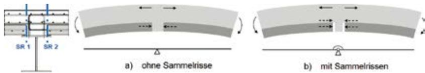
Bild 7 Längsschnitt Fahrbahn am Querträger mit lokaler Tragwirkung bei möglichen Sammelrissen
