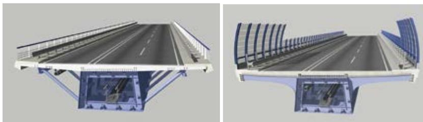
Bild 16 Gottleubatalbrücke – Regelquerschnitt mit Schrägstreben aus dem Wettbewerb (links), Regelquerschnitt mit Konsolen aus der Entwurfsplanung mit ergänzten Wind- und Kollisionsschutzwänden (rechts) Grafiken: DEGES/Schüßler-Plan/A. Keipke
