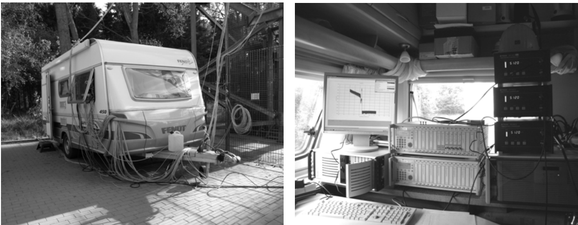
Bild 4: Messwarte im Wohnwagen (Basisstation) unter der Brücke, Messverstärker und -computer
