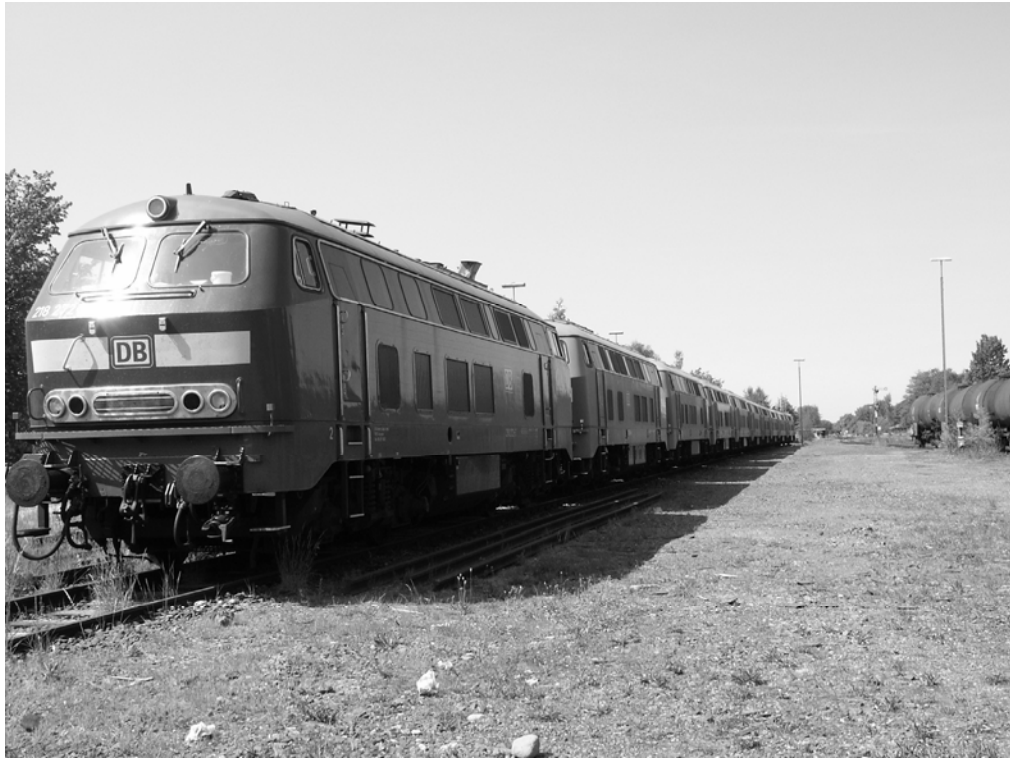
Bild 5: Belastungszug, bestehend aus 10 Loks BR 218
