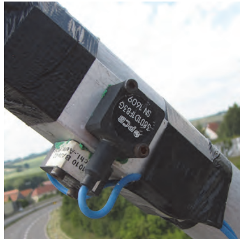
Bild 4: Uniaxiale Beschleunigungssensoren, in und aus der Seilebene messend [7]
